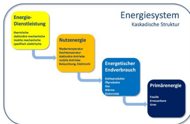
Abbildung 5-3 Die Elemente der Energiekaskade
